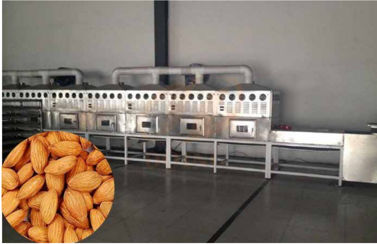
Şekil 20. Bademin Kapalı Ortamda Isı ile Kurutulması
